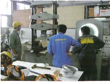
●北海道大学 野口研究室 木質材とコンクリートの接合にJBRAシートを用いた曲げ試験
